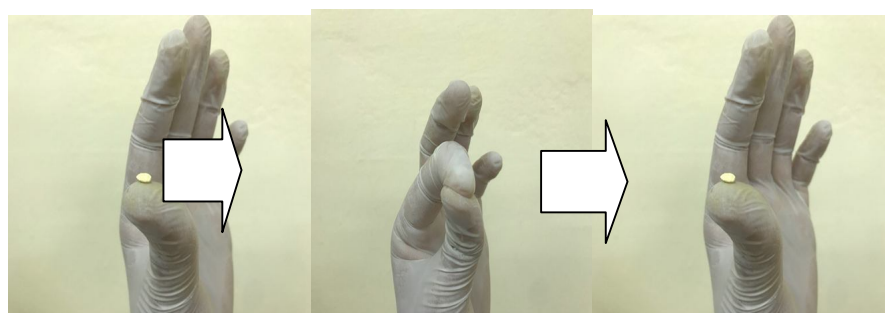
Рис.4. Отсутствие прилипания у ПТФЭ
